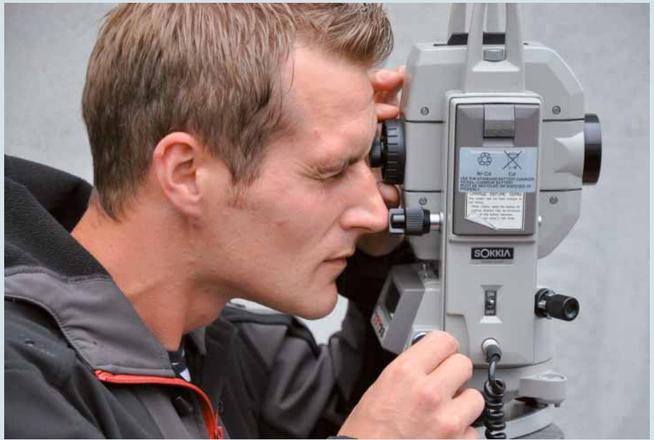
Michael Falz an der Totalstation – die Firma nutzt eine von Sokkia, die für die CAD-Software modifiziert wurde.
