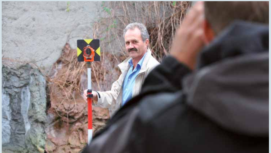
Einfache Arbeit mit schnellem Ergebnis und großem Erfolg. Während Roland Müller die Prismenstange ausrichtet, bereitet Techniker Michael Falz die Totalstation vor.
